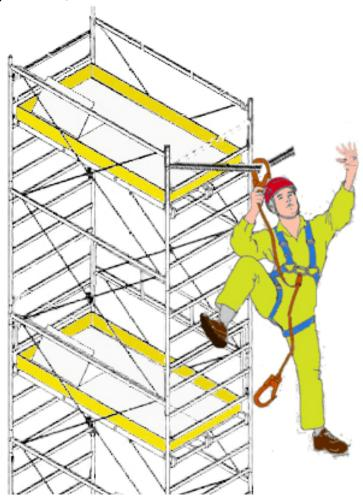
Ricordiamo che per lavorare in modo corretto e rispettoso delle norme dettate ai sensi della UNI EN 795 il punto di ancoraggio deve essere capace di resistere a uno sforzo non inferiore a 10 kN come si evince dalla tabella seguente;
