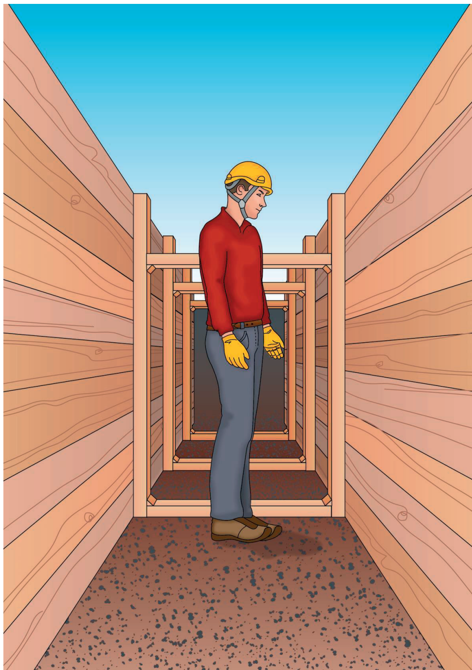
Figura 1 - Sistema realizzato totalmente in legno
